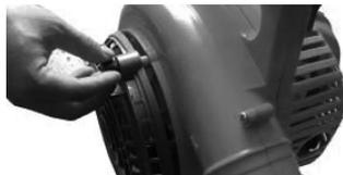
Installez les tubes d'aspiration dans la séquence indiquée, en alignant les fentes de la buse avec les chevilles.
