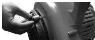
Instalar los tubos de aspiración en la secuencia que se muestra, alineando las ranuras en las boquillas con las clavijas. Deslice las boquillas en el sentido de las agujas del reloj en las clavijas. (Fig. 5).
