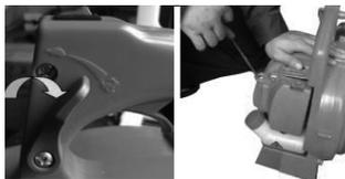
Une fois chaud, le moteur doit démarrer sur la première traction. S'il ne démarre pas, appuyez à nouveau sur la pompe d'injection et assurez-vous que le levier du starter se trouve dans la position correcte. (Fig.13).
