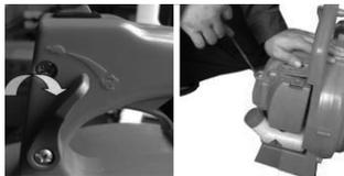
Deixe o motor trabalhar 10 a 20 segundos e depois puxe a alavanca do estrangulador totalmente para cima. Uma vez quente, o motor deve arrancar na primeira puxada. Se ele não arrancar, volte a pressionar a bomba de injeção e garanta que a alavanca do estrangulador está na posição correcta. (Fig 13).
