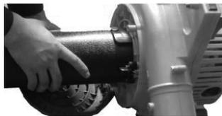
Girar o tubo conector para bloquear, a ponta da seta no tubo conector deve estar na mesma linha com o bocal. (Fig. 6).
