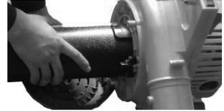
Gire el tubo conector hacia la derecha para bloquear, la punta de flecha en el tubo conector debe estar en la misma línea con la caja de espirales. (Fig. 6).
