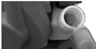
Vérifiez périodiquement le filtre à carburant. Ne laissez pas entrer la poussière dans le réservoir de carburant. Un filtre obstrué causera des difficultés dans le démarrage du moteur ou des anomalies dans les performances du moteur. Lorsque le filtre est sale, il doit être remplacé.
