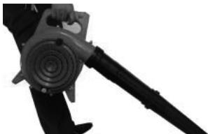
Puxe o acelerador. Defina o acelerador para a velocidade desejada pressionando o botão para a posição de bloqueio. Para ajustar a velocidade de aceleração, empurre o bloqueio do acelerador para a posição desligado, ajuste e bloqueie novamente o acelerador.
