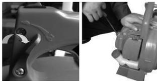
Una vez caliente, el motor se debe iniciar en el primer tirón. Si no se inicia, pulse de nuevo la bomba de inyección y asegúrese de que la palanca del estrangulador está en la posición correcta (Fig. 13).
