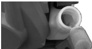
Verifique o filtro de combustível periodicamente. Não permita que entre poeira no tanque de combustível. Um filtro entupido irá causar dificuldade no arranque do motor ou anormalidades no desempenho do motor.
