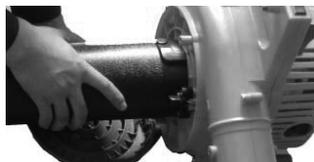
Tournez le tube connecteur pour verrouiller, la pointe de la flèche dans le tube connecteur doit être alignée avec la buse. (Fig. 6).
