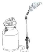
Il est nécessaire d'effectuer un essai de pulvérisation avec de l'eau propre et de vérifier l'étanchéité du réservoir, du tuyau, du robinet d'arrêt et de la buse avant l'utilisation.
