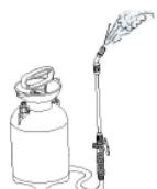
É necessário efetuar um teste de pulverização com água limpa e verificar o depósito, a mangueira, a válvula de corte e o bico quanto a possíveis fugas antes da operação.
