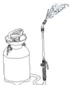
Machen Sie einen Sprühtest mit sauberem Wasser und überprüfen Sie Tank, Schlauch, Abschluss und Düse auf mögliche Leckagen, welches vor dem Betrieb erforderlich ist.
