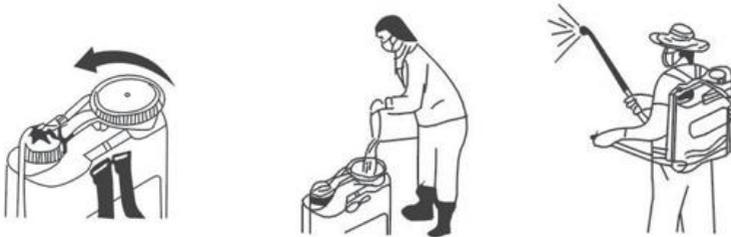
Schrauben Sie den Deckel des Tanks ab und füllen Sie ihn vorsichtig mit vorbereiteter Mischung durch das Sieb. Schließen Sie dann den Tankdeckel. Schnallen Sie die Rückenspritze auf den Rücken. Schwenken Sie den Schwingarm, um Druck aufzubauen. Drücken Sie dann den Schalter, um in kurzen Stößen oder kontinuierlich zu sprühen.
