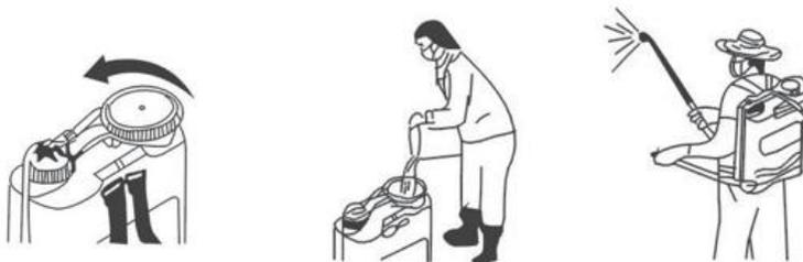
Desaperte a tampa do depósito e encha-o cuidadosamente com a mistura preparada através de um coador. Coloque o pulverizador nas suas costas e acione a alavanca basculante para aumentar a pressão na câmara de ar e, em seguida, prima o botão para pulverizar de forma localizada ou contínua.
