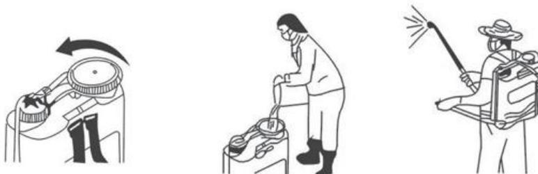
Desserrez le couvercle du réservoir et remplissez-le avec précaution du mélange préparé en le faisant passer par une passoire. Placez le pulvérisateur sur votre dos et actionnez le levier à bascule pour augmenter la pression dans la chambre à air, puis appuyez sur le bouton pour une pulvérisation localisée ou continue.
