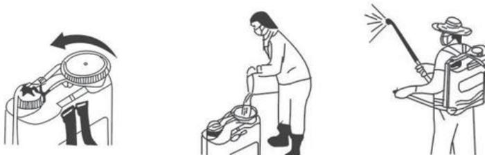
Desenrosque la tapa del depósito y llénelo cuidadosamente con la mezcla preparada a través de un colador. Coloque el pulverizador a su espalda y accione la palanca basculante para aumentar la presión en la cámara de aire, luego pulse el botón para pulverización localizada o continua.
