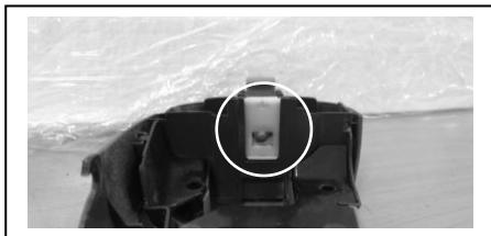
Une utilisation en continue de la tronçonneuse en mode antigel même lorsque les températures augmentent et reviennent à la normale peut entraîner un démarrage incorrect du moteur ou l'impossibilité de faire fonctionner le moteur à sa vitesse normale. C'est pourquoi vous devez toujours vous assurer de mettre la fenêtre antigel en mode fermé s'il n'y a pas de risque de glace.
