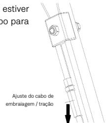
Se a alavanca do travão estiver solta, deve rodar o ajuste do cabo para apertar.
