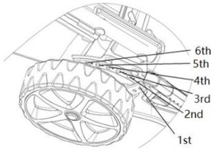
**!** La cuchilla puede causar lesiones graves. Parar el motor antes de ajustar la altura de corte.
