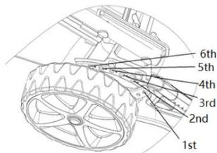
**!** A lâmina pode causar ferimentos graves. Pare o motor antes de ajustar a altura de corte.
