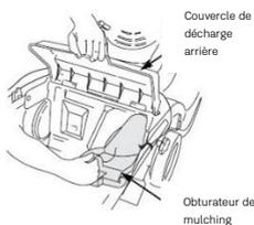
L'obturateur mulching permet de courber l'intérieur de la base de la tondeuse pour une broyage plus efficace. Installez et retirez l'obturateur mulching en soulevant le couvercle de l'éjection arrière. L'obturateur mulching ne se monte que dans un sens. Retirez-le lorsque vous utilisez le bac de ramassage.
