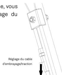
Si le levier de frein est lâche, vous devez tourner l'écrou de réglage du câble pour le serrer.
