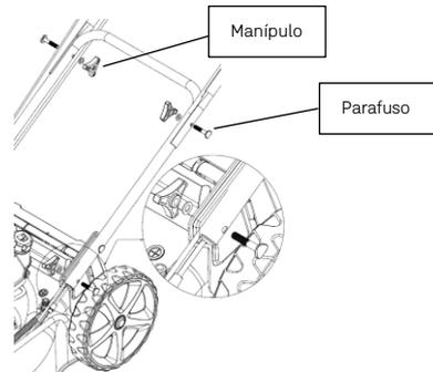
A pega tem duas posições de ajuste em altura "L" ou "H".
