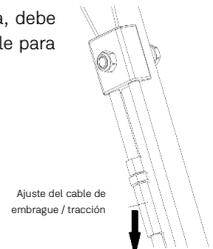
Si la palanca de freno está floja, debe girar la tuerca de ajuste del cable para apretarla.
