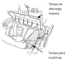
A tampa para mulching ajuda a curvar o interior da base da máquina de relva para uma mulching mais eficiente. Coloque e retire a tampa para mulching levantando a tampa de descarga traseira. A tampa para mulching só se encaixa de uma forma. Retire-a quando utilizar o saco de relva.
