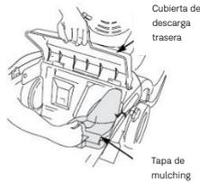
La tapa de mulching ayuda a doblar el interior de la base del cortacésped para un triturado más eficiente. Coloque y retire la tapa de mulching levantando la cubierta de descarga trasera. La tapa de mulching se ajusta en un solo sentido. Retírala cuando uses la bolsa de recogida de hierba.
