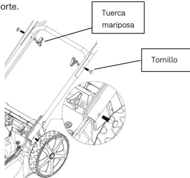
La empuñadura tiene dos posiciones de ajuste de altura "L" o "H".
