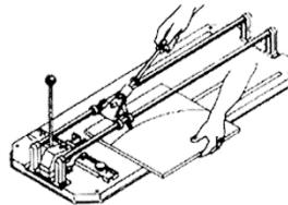
**PT** Para fazer um corte curvo, marque previamente a peça com um lápis, se necessário. Em seguida, risque segundo a marcação, colocando antes uma outra cerâmica por baixo, a fim de permitir a rotação enquanto risca.
