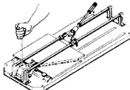
**PT** Para efectuar cortes na diagonal, risque a cerâmica previamente. Coloque a cerâmica de maneira a que o ponto inferior coincida com a linha de corte e accione a alavanca do separador.
