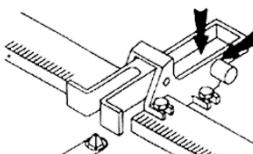
**PT** Se o pó acumulado impede o bom funcionamento, limpe e lubrifique as partes assinaladas com óleo lubrificante, apesar das corredeiras estarem munidas de casquilhos autolubrificantes. Ao retirar a tampa plástica de protecção do separador, tem acesso aos pontos indicados para realizar a sua lubrificação e limpeza periódica.
