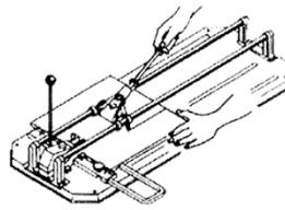
**PT** Colocar a cerâmica sobre a base na parte superior do esquadro numerado. Para maior precisão, utilize o topo de apoio lateral. Riscar de uma só vez, pelo lado esmaltado. Uma vez riscada a peça, puxe para si e com força a alavanca do separador.
