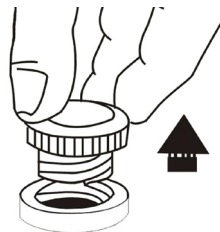
Schéma 1: défaites ou enlevez la prise de batterie.
