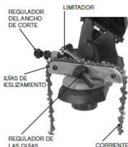
Ajustar la separación de las guías de deslizamiento con el fin de tener la distancia mínima para la cadena deslizarse sin esfuerzo.
