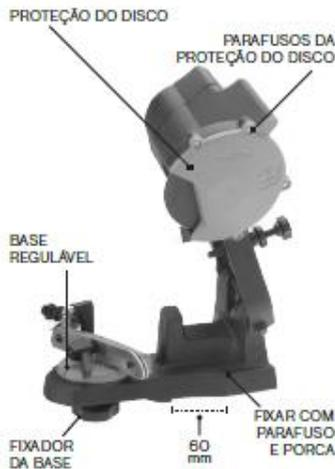
Ao instalar o afiador de correntes na bancada, assegure-se de que o fixador (roda de plástico com porca metálica no interior) da base regulável está acessível.
