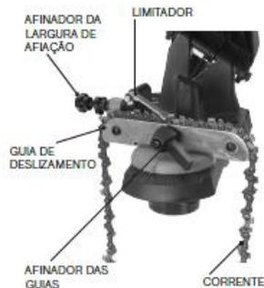
Ajuste o afastamento das guias de deslizamento por forma a ter o mínimo de folga para a corrente deslizar sem esforço.
